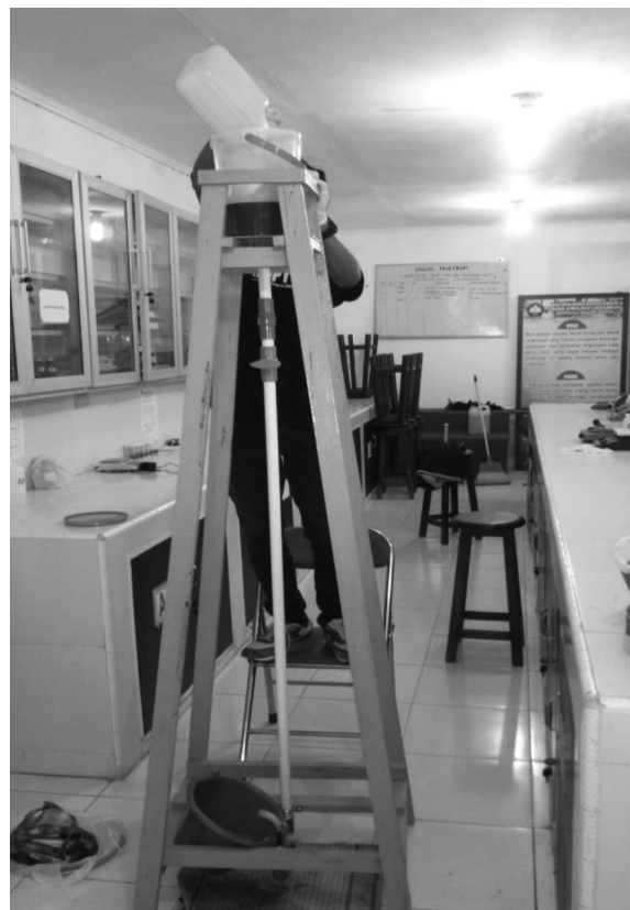
Gambar 3.1 peralatan adsorpsi Methylene blue secara kontinyu skala laboratorium
